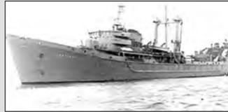
24 грудня 1964 року в Миколаєві на суднобудівному заводі ім. 61 комунара спущено на воду рятувальне судно «Карпати» водотоннажністю 5600 т, призначене для порятунку особового складу та підйому аварійних підводних човнів з глибин до 300 м.
